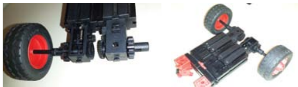
Slika 3.41: Spajanje kotača i osovine u kombinaciji s oplatom i maticama
