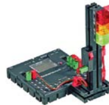
Slika 3.52: Primjer spajanja tipkala, žaruljica i sučelja
