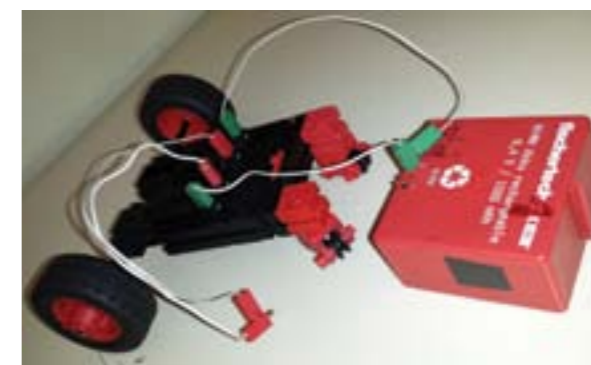
Slika 3.43: Spajanje izvora napajanja na robotska kolica pomoću vodiča
