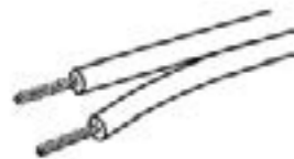
Slika 3.14: Skinuta izolacija sa žice
