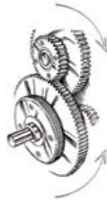
Slika 3.29: Prikaz rada zupčanika
