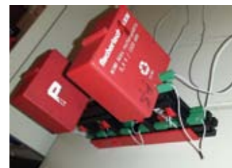
Slika 3.45: Spajanje izvora napajanja na tipkala (za ručno upravljanje vozilom)
