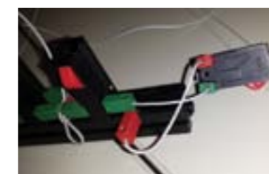
Slika 3.44: Slaganje tipkala za upravljanje robotskim kolicima
