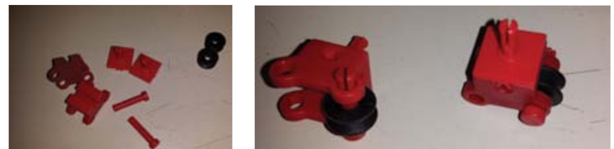
Slika 3.38: Slaganje dodatnih kotača za stabilnost kolica
