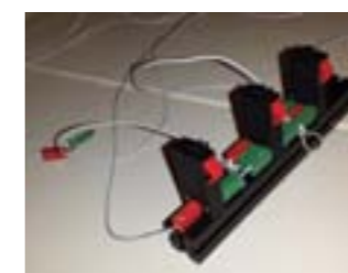
Slika 3.44: Slaganje tipkala za upravljanje robotskim kolicima
