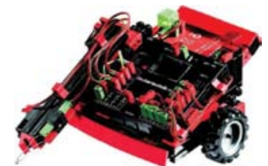
Slika 3.53: Primjer spajanja robotskih kolica i sučelja
