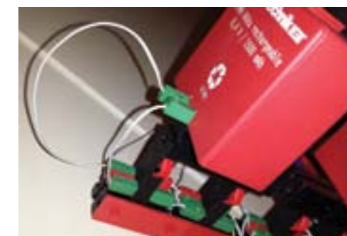
Slika 3.45: Spajanje izvora napajanja na tipkala (za ručno upravljanje vozilom)
