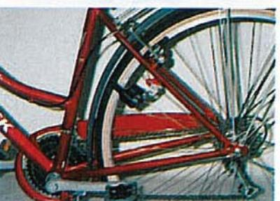
Zategnutost lanca provjeri pritiskom na gornji dio lanca. Dozvoljeni progib lanca smije iznositi oko jedan centimetar. Ako na biciklu postoji štitnik lanca, on ne smije biti iskrivljen i ne smije sprječavati normalno okretanje lanca.
