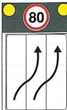
**Pokretna signalna ploča s promjenjivim sadržajem**
